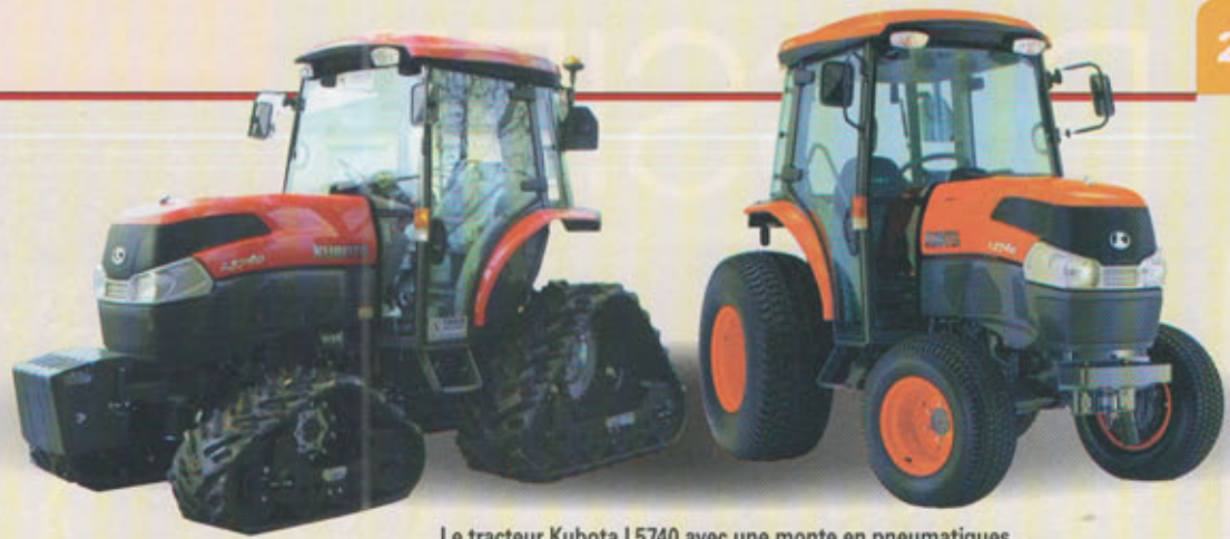
Le tracteur Kubota L5740 avec une monte en pneumatiques et en version chenilles après le montage de l'équipement Soucy Track.
