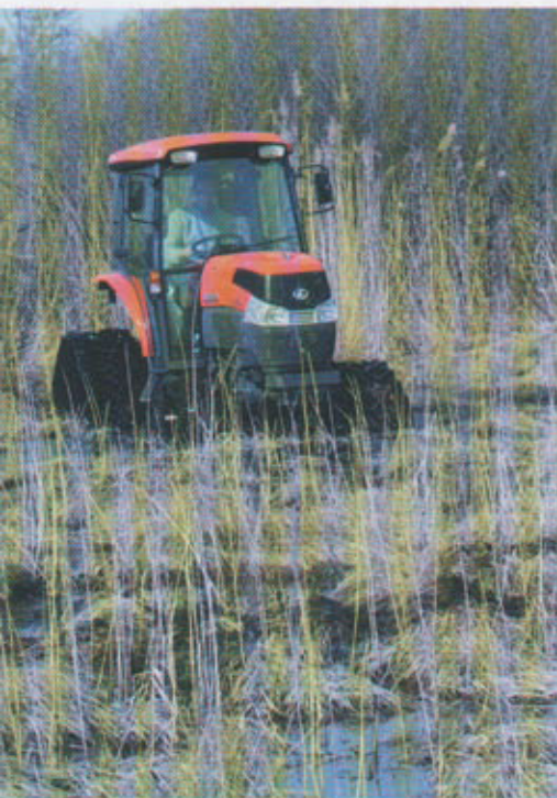
Intervenir dans un marais est possible avec un tracteur chenillé, là où un tracteur conventionnel resterait enlisé.
