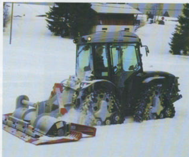
Le tracteur Antonio Carraro Mach4, articulé et à poste de conduite réversible, est équipé d'origine de chenilles Soucy Track. Il est adapté aux travaux dans les vignes et pour des applications en station de ski. Il se distingue par ses capacités de traction et de stabilité.
